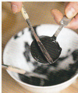
Quark, Sumpfkalk, Wasser und Pigmente sind die Basis für Kalkkaseinfarbe. Der Quark wird mit Sumpfkalk als Bindemittel leicht gelblich.
