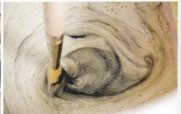
Quark, Sumpfkalk, Wasser und Pigmente sind die Basis für Kalkkaseinfarbe. Der Quark wird mit Sumpfkalk als Bindemittel leicht gelblich.
