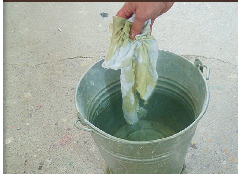
Mit Grundieröl getränkter Lappen: Zustand nach ca. 3 Stunden unter Idealbedingungen: 30°C Lufttemperatur, Windstille und direkter Sonneneinstrahlung
