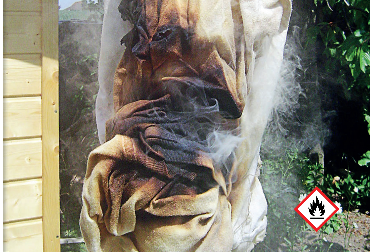
Mit Grundieröl getränkter Lappen: Zustand nach ca. 3 Stunden unter Idealbedingungen: 30°C Lufttemperatur, Windstille und direkter Sonneneinstrahlung
