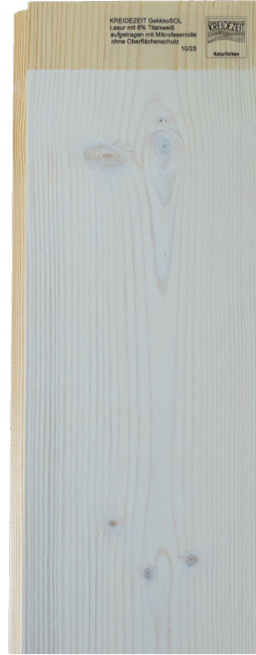
GekkoSOL Lasur ohne Oberflächenschutz 2%, 4%, 6% und 10% Titanweiß
