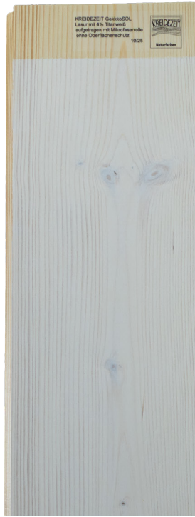
GekkoSOL Lasur ohne Oberflächenschutz 2%, 4%, 6% und 10% Titanweiß
