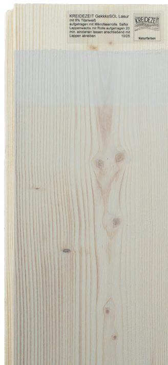
GekkoSOL Lasur mit Oberflächenschutz Saflor Lappenwachs 10%, 6% und 4% Titanweiß
