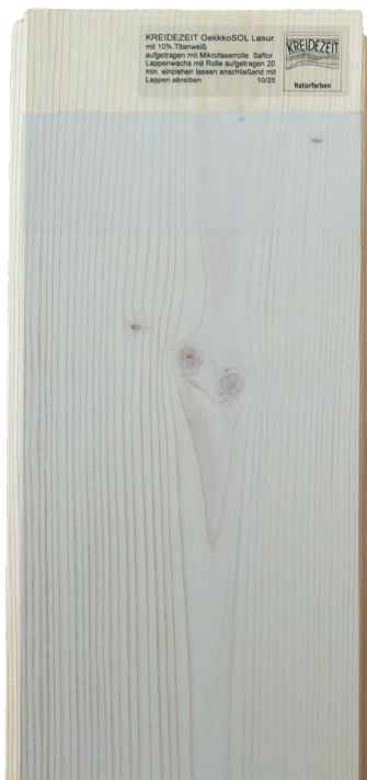
GekkoSOL Lasur mit Oberflächenschutz Saflor Lappenwachs 10%, 6% und 4% Titanweiß
