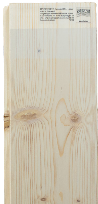
GekkoSOL Lasur mit Oberflächenschutz Saflor Lappenwachs 10%, 6% und 4% Titanweiß
